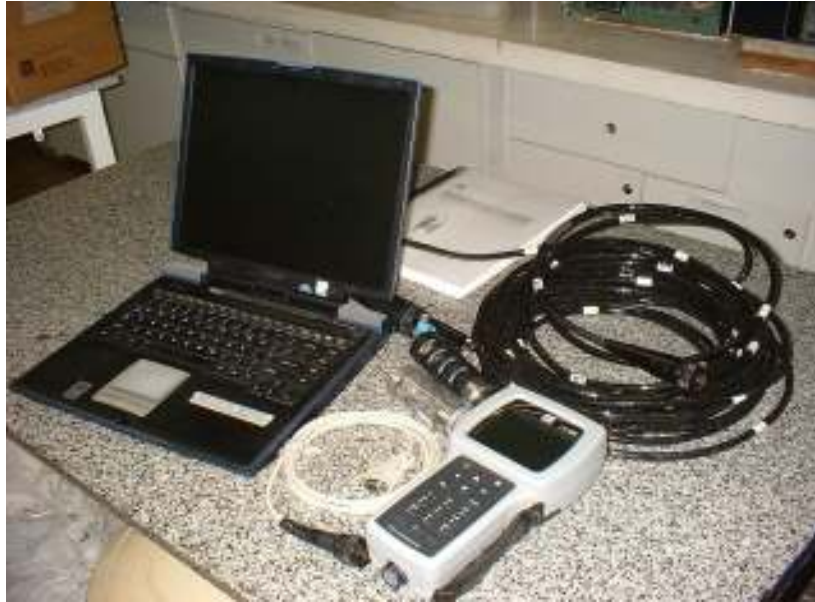
Fig. 02- Sonda multi-parâmetro YSI 556 que é capaz de medir e estocar em memória os seguintes parâmetros: temperatura, condutividade, pH, potencial REDOX e oxigênio dissolvido.
