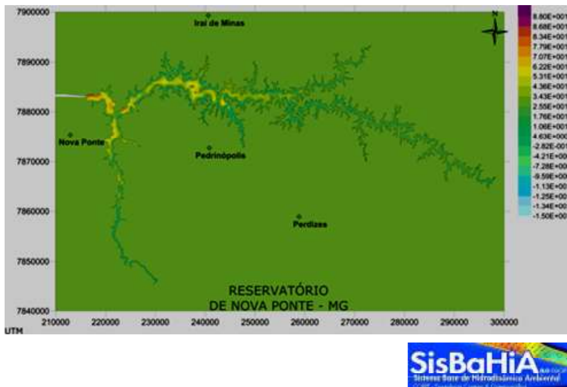
Fig. 06 – Carta batimétrica preliminar do Reservatório de Nova Ponte, obtida através do programa Surfer 9.0®-Sisbahia®. Dados obtidos em agosto de 2008 com o sonar OHMEX® acoplado ao D-GPS Techgeo®. Coordenadas pós-processadas com dados das estações da rede brasileira de estações de geo-referenciamento do IBGE.
