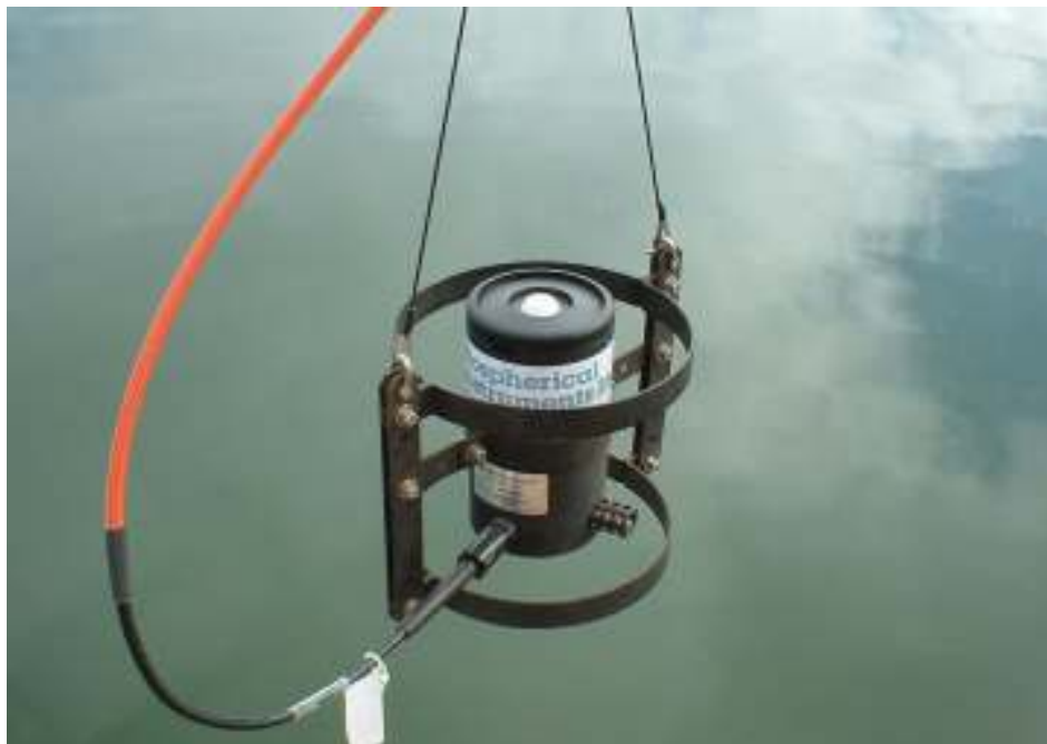
Fig. 03- Sonda Biospherical que é capaz de medir e estocar dados de perfis de radiação solar na coluna de água em três regiões distintas do espectro solar (PAR, UV-A e UV-B).
