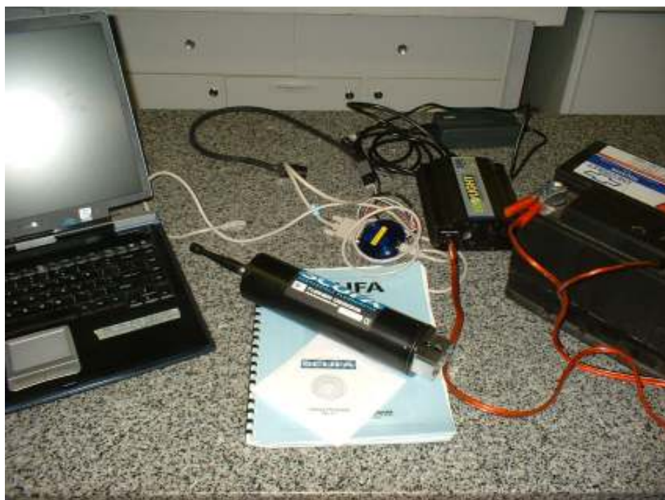
Fig. 04- Sonda fluorimétrica SCUFA, da Turner Designs que é capaz de medir tanto in situ quanto em laboratório, a clorofila-a e a turbidez da água.
