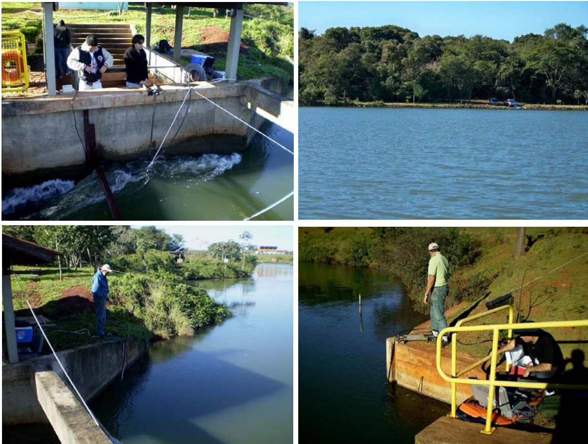
Fig. 18 – Quatro diferentes momentos dos trabalhos de prospecções hidroacústicas no sistema de transposição de peixes (Canal da Piracema) de Itaipú. Esse canal desemboca em uma pequena lagoa artificial, a Lagoa Principal (à direita em cima). Essa lagoa foi totalmente percorrida em vários trajetos em zigue-zague para a obtenção de dados de morfometria e de posicionamento de peixes (ver próxima figura).
