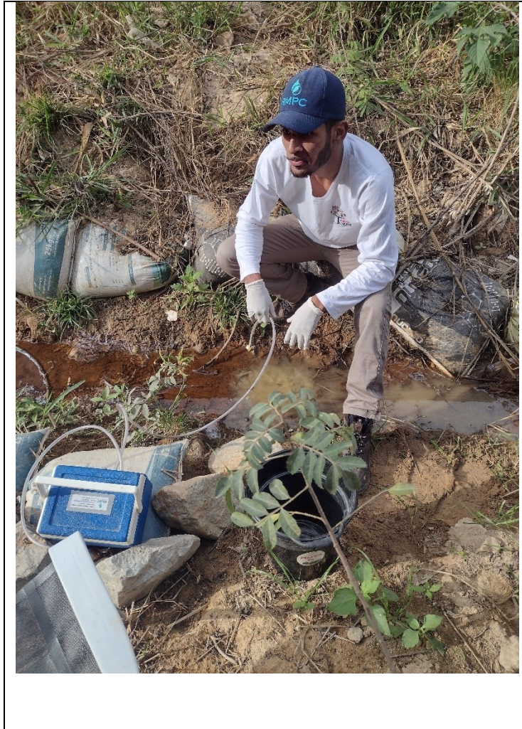
Figura 4.– Aparato desenvolvido pela RMPC que permite a coleta de amostras de água em microhabitats rasos, onde é impossível a coleta com balde. A novidade evita distúrbios na coleta que podem modificar a qualidade de água e causar erros nos resultados.
