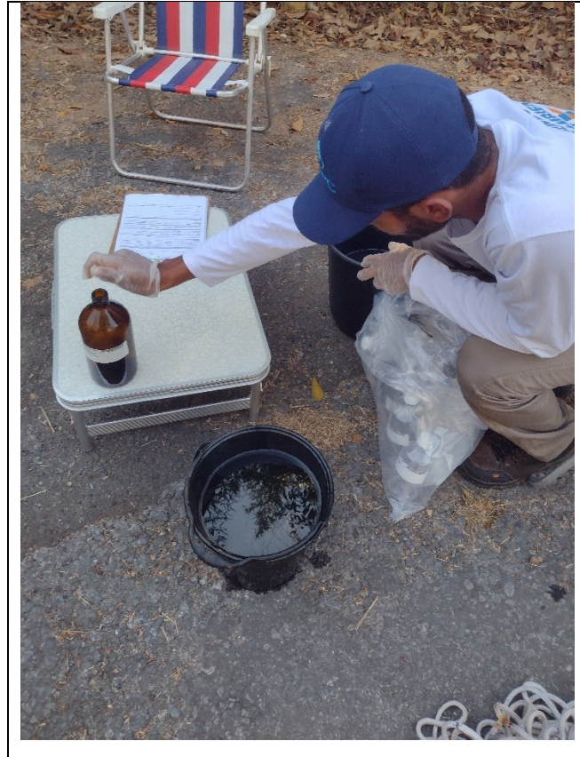
Figura 2.- Coleta da amostra com um balde e subdivisão em alíquotas em frascos apropriados para cada tipo de análise da água.
