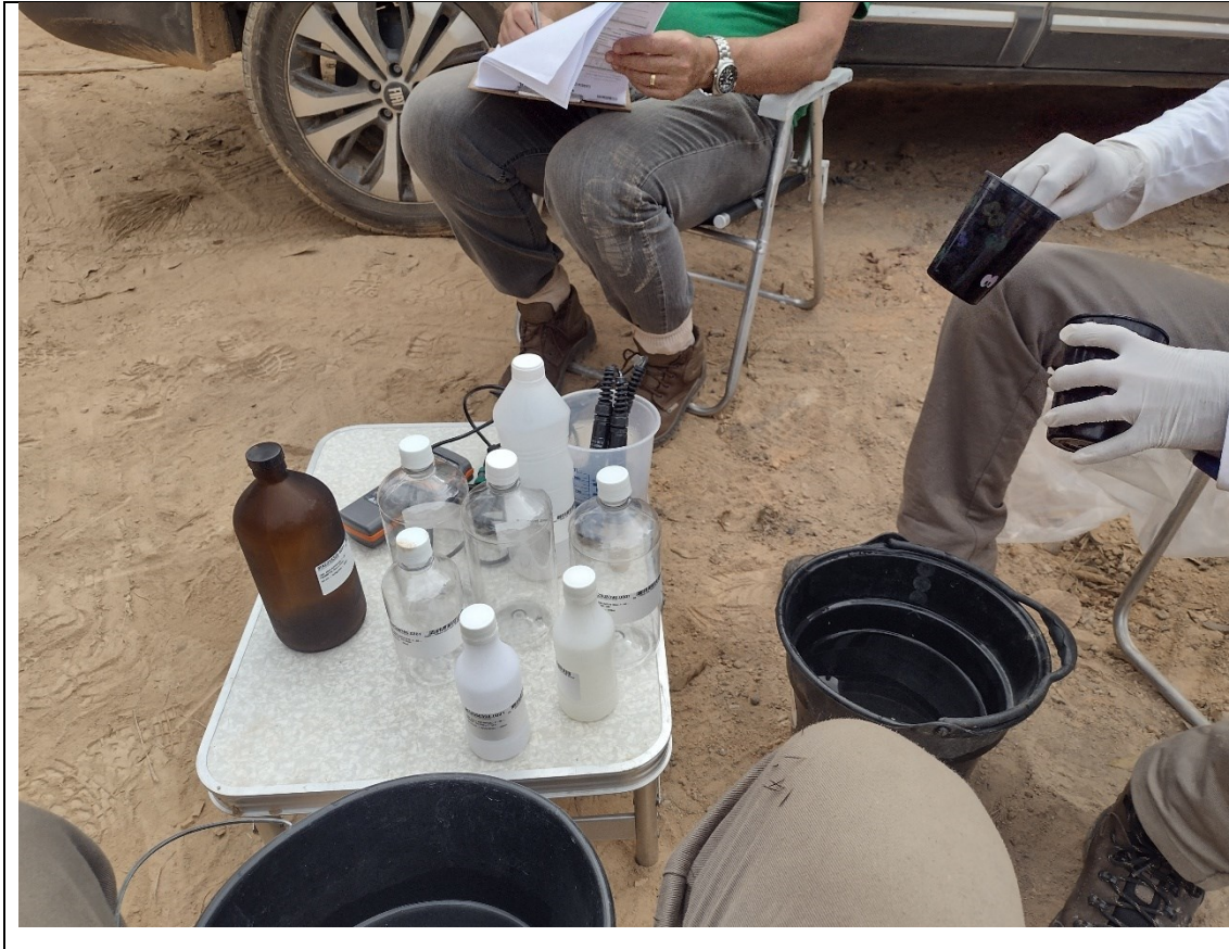
Figura 3.– Sonda limnológica adquirida com recursos do FSA (ACF/209) que está sendo usada no programa de monitoramento da qualidade de água.
