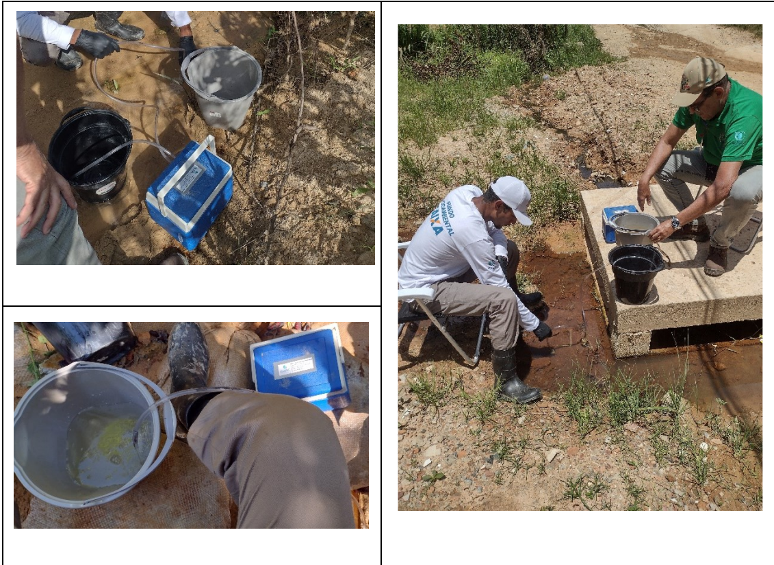
Figura 4.– Aparato desenvolvido pela RMPC que permite a coleta de amostras de água em microhabitats rasos, onde é impossível a coleta com balde. A novidade evita distúrbios na coleta que podem modificar a qualidade de água e causar erros nos resultados.
