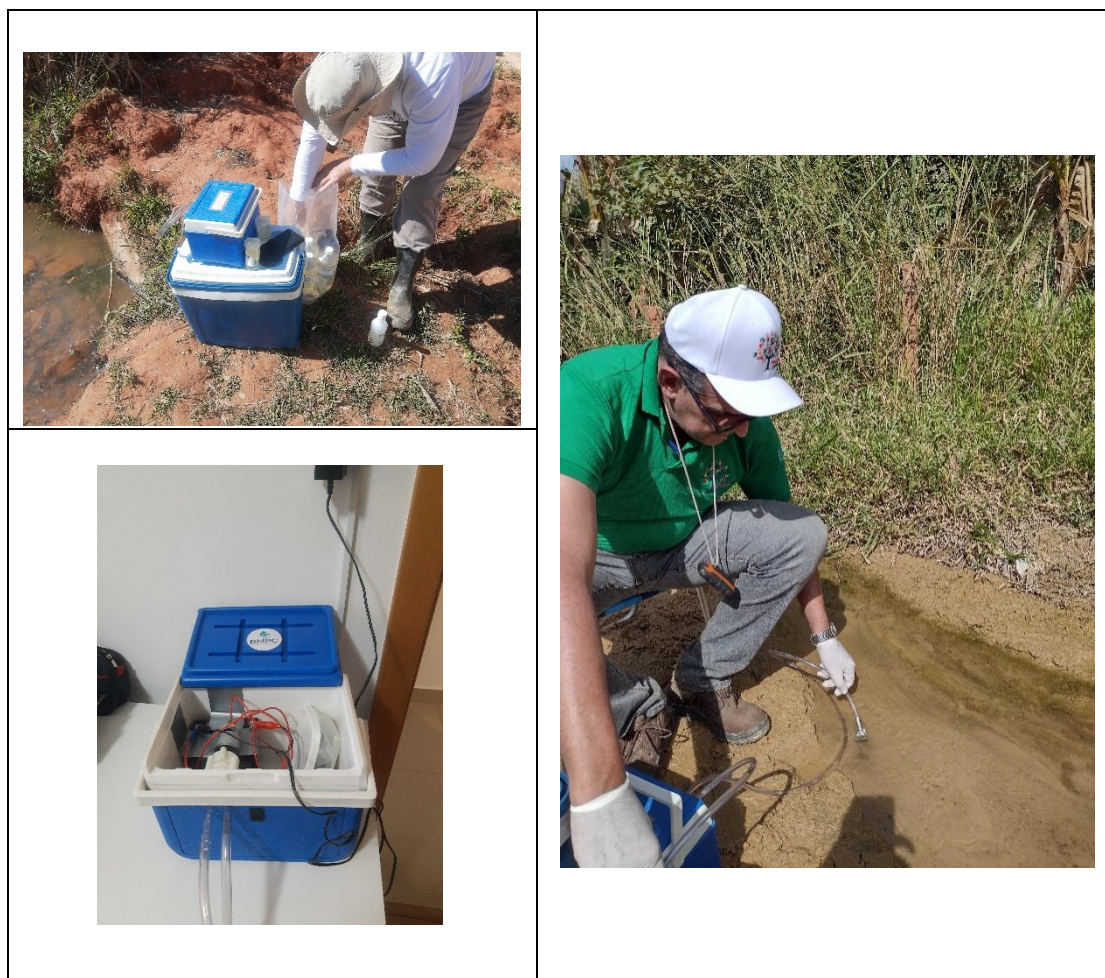
Figura 4.– Aparato desenvolvido pela RMPC que permite a coleta de amostras de água em microhabitats rasos, onde é impossível a coleta com balde. A novidade evita distúrbios na coleta que podem modificar a qualidade de água e causar erros nos resultados.
