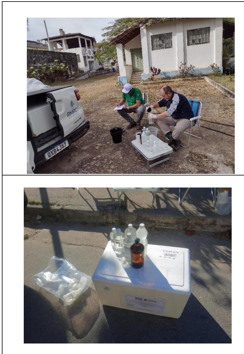
Figura 2.- Coleta da amostra com um balde e subdivisão em alíquotas em frascos apropriados para cada tipo de análise da água.
