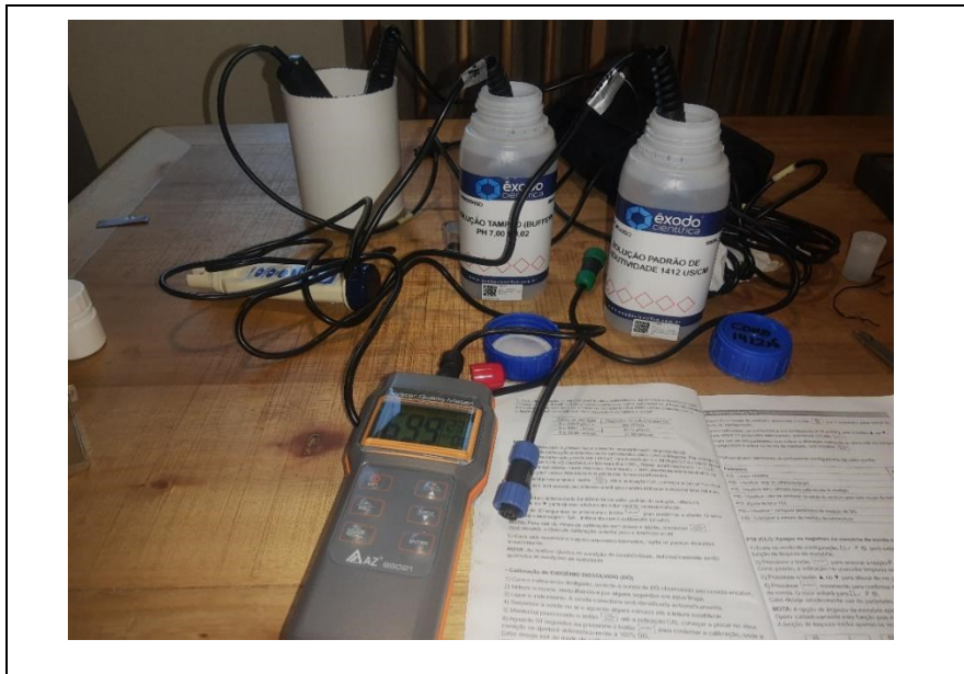
Figura 3.– Sonda limnológica adquirida com recursos do FSA (ACF/209) que está sendo usada no programa de monitoramento da qualidade de água.
