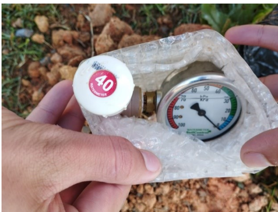
FOTO 05 – Medindo a quantidade de água no solo
