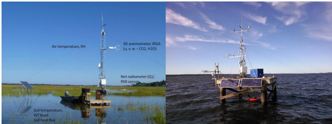
Figura 1 – (A) Torre de Eddy Covariance instalada no centro do reservatório Ross Barnett (Mississippi, EUA), nesta torre são medidas a troca líquida de dióxido de carbono, evapotranspiração e fluxo energético. (B) Torre de Eddy Covariance instalada no centro do reservatório Ross Barnett (Mississippi, EUA), nela são medidos os parâmetros meteorológicos (pressão atmosférica, temperatura do ar, umidade relativa do ar, direção e velocidade do vento, fluxo de calor latente, fluxo de calor sensível, fluxo de dióxido de carbono, radiação líquida, radiação de onda curta e longa, precipitação) e temperatura superficial da água e em diferentes profundidades do reservatório.
