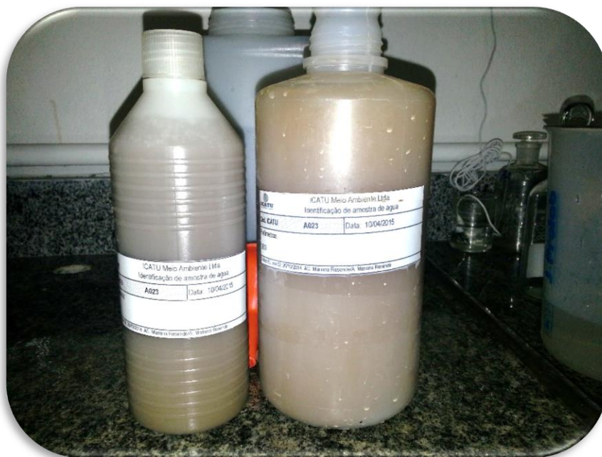
Figura 2. Amostras coletadas no ponto 3 de monitoramento para análise de DBO e DQO.
